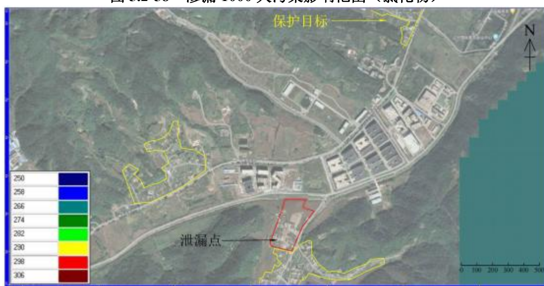
图 5.2-59 渗漏 3650 天污染影响范围（氯化物）
