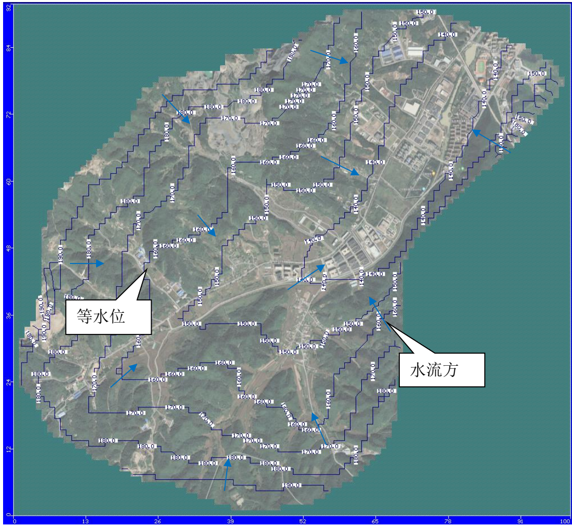
图 5.2-37 项目水位拟合及地下水流场
