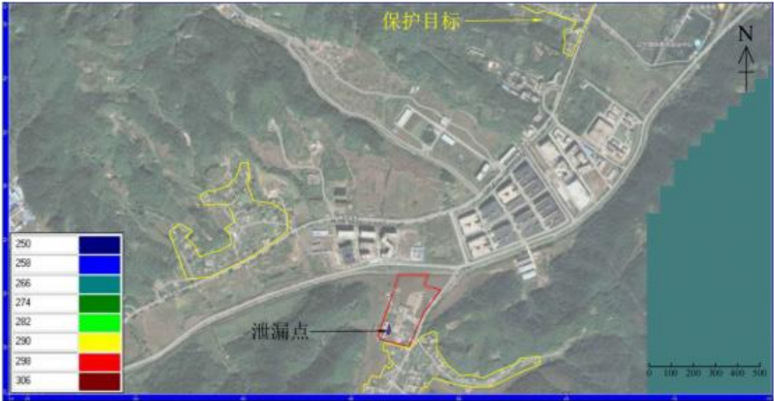
图 5.2-54 渗漏 33 天污染影响范围（氯化物）
