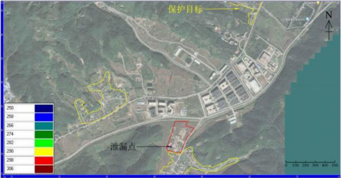
图 5.2-51 渗漏 10 天污染影响范围（氯化物）
