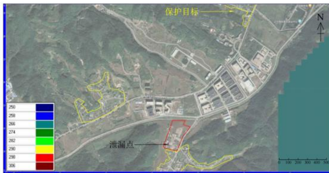
图 5.2-55 渗漏 34 天污染影响范围（氯化物）
