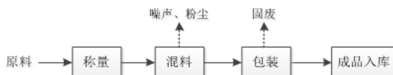
图 2-10 生产工艺流程及排污节点示意图
